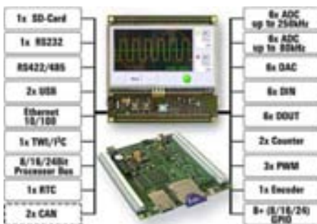
Bild 3: Herzstück des Starterkits ist der universelle Messrechner ZMC für Embedded-Mess-/Regeltechnikaufgaben.
