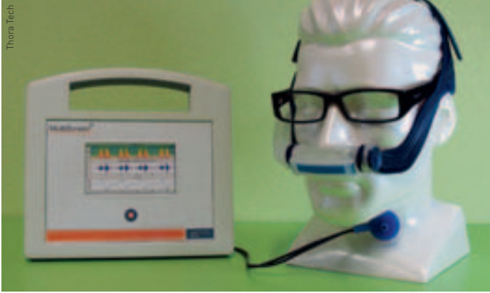
Das akustische Spirometrie-System nimmt die Atemgeräusche in der Luftröhre auf und kann so Atemstörungen detektieren.
