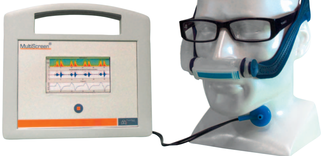
5 Aufbau eines akustischen, mobilen Spirometrysystems mit 4,3-Zoll-Farb-Multitouch-Display und trachealem Mikrofon
