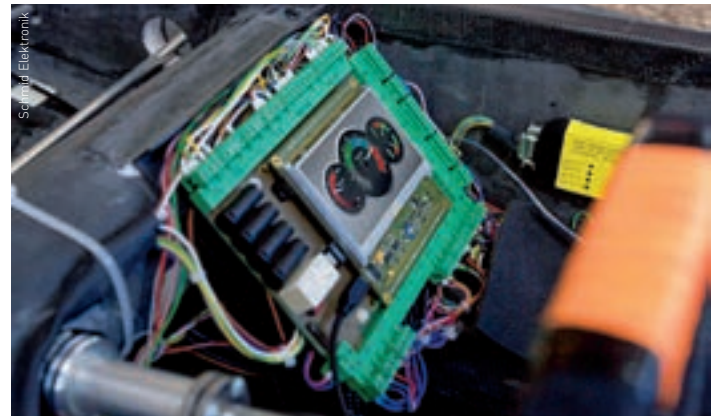
Im Begleitfahrzeug sind alle wichtigen Betriebsdaten auf einen Blick auf dem Monitor erkennbar: die Fotovoltaik-Leistung (grün), die Batteriespannung (rot), die Motorleistung (orange) und die resultierende Fahrzeug-Geschwindigkeit (blau).
