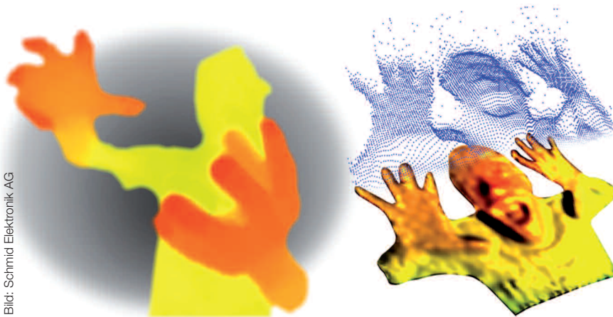
Bild 3 | Vom 3D-Tiefenbild des 3D-Sensors (links) über die in LabView berechnete 3D-Punktwolke (oben rechts) im Handumdrehen zu räumlichen Merkmalen und 3D-Visualisierung (unten rechts)
