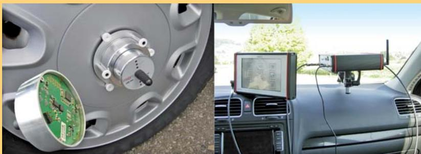
In dezentralen, miniaturisierten Messknoten werden Sensordaten erfasst, drahtlos an eine Blackbox weitergeleitet, dort live auf einem farbigen TFT-Touchdisplay angezeigt, über gängige Schnittstellen an Fremdsysteme übertragen und auf mobilen Speichermedien aufgezeichnet.
