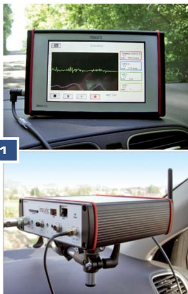
Bild 1. Drehzahlsensoren in den Radnaben senden ihre Daten an eine Blackbox (unten rechts) mit Touchdisplay (oben rechts), Datenspeicher und Telemetrie-Interface
