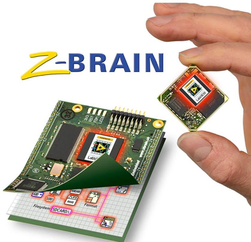
Kompakte Rechner bis Scheckkarten-/Briefmarkenformat, 24/7-Betrieb, ohne Betriebssystem, für Embedded Mess-/Steuer- und Regelaufgaben mit kundenspezifischen Baseboards. Für Rapid Prototyping/ Produktentwicklung/ Serie :
