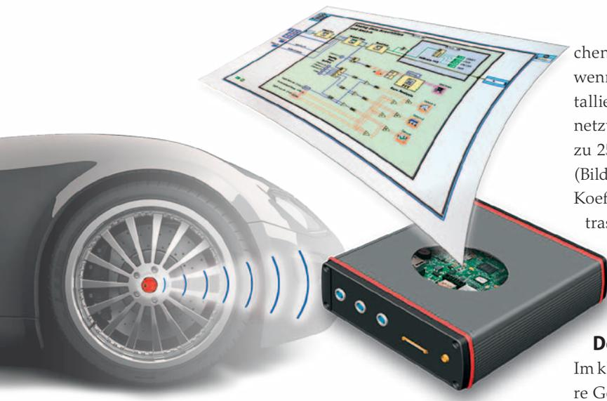
**Bild 5:** Batteriebetriebene Rotationssensoren sind in jeder Radnabe montiert und übertragen die Raddrehzahlen drahtlos an ein Single-Board-RIO-NI-sbRIO-9636.
