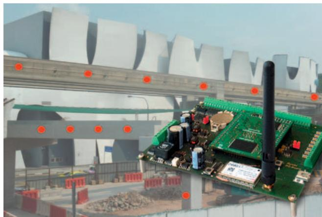
**Bild 7:** Dezentrale, batteriebetriebene Messknoten mit Labview-Scheckkartenrechnern werden an Gebäuden, Brücken sowie an anderen kritischen Strukturen montiert (rot) und messen deren Vibrationen und Lageverschiebungen.
