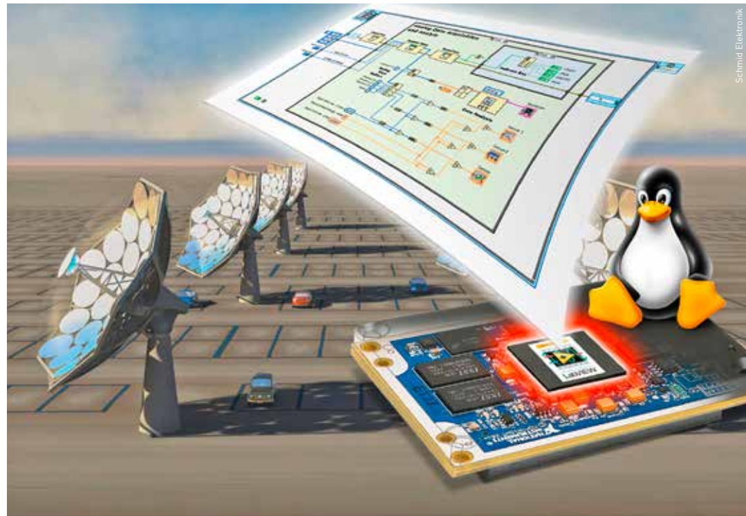
Die Embedded-Anwendung der «Sonnenblume» ist grafisch mit Labview programmiert und wird als robuster Echtzeit-Code auf Linux und ARM-Mikrocontroller betrieben.
