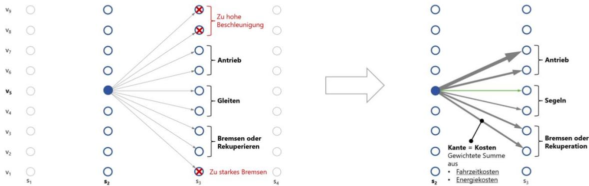
Bild 12 | Eingrenzen ungültiger Folgezustände aufgrund extremer Beschleunigungen (links) und Berechnen der Kantengewichte mit den Entscheidungskosten (rechts).
