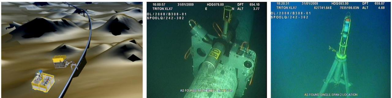
Bild 3 | Ein Remote Operating Vehicle (ROV, links) verankert das CSP (Clamp Sensor Package, mitte) auf der Pipeline und das MSP (Master Sensor Package, rechts) auf dem Meeresboden.
