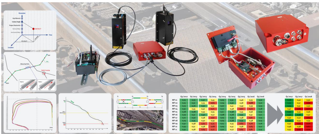
Bild 6 | Lasergestützte, automatisierte Zustandsüberwachung von Bahnschienen-Infrastruktur: Zwei Laserscanner (schwarz) sind mit dem Hauptrechner (rote Box) verbunden und werden von LabVIEW Embedded gesteuert. Die Messdaten werden nach einem Netzplan strukturiert abgelegt, verarbeitet und jedem stufengerecht zugänglich gemacht.
