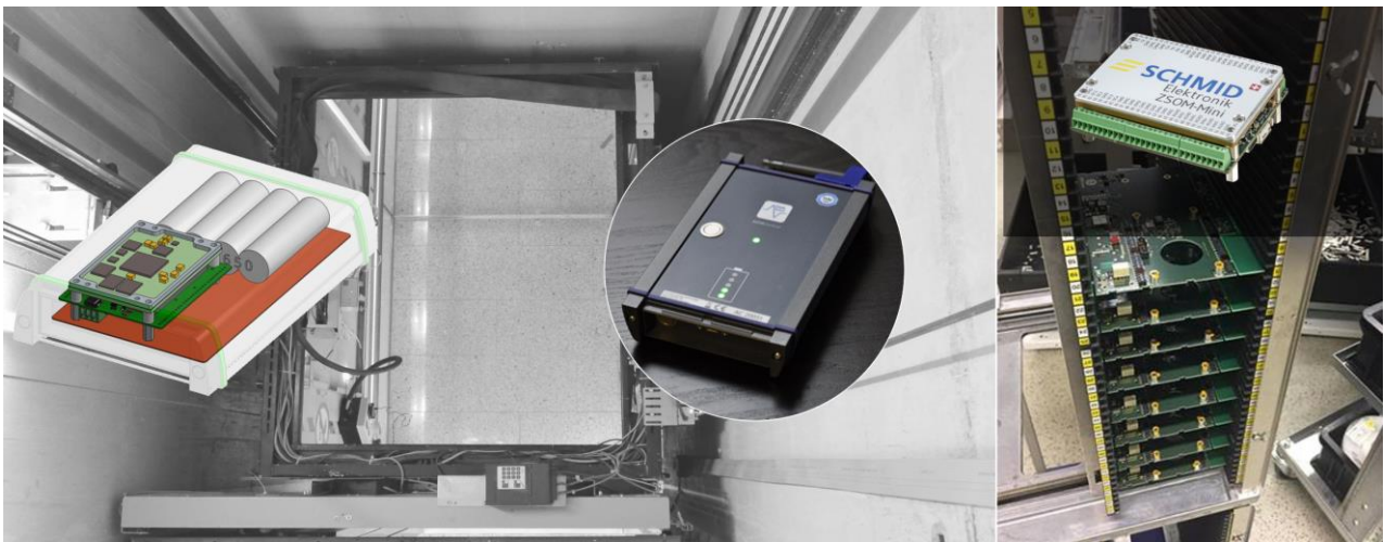
Bild 18 | Ein akkubetriebener Messhandheld für den Aufzug enthält einen hochpräzisen Beschleunigungssensor und kommuniziert die Daten über WIFI an das Tablet.
